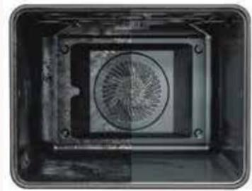
自清程序進行時烤箱會加熱到 480 度，只留下烤箱冷卻後，可以簡單用抹布擦去的灰燼。根據髒汙的不同，烤箱可以設定 1 小時、1.5 小時、2.5 小時的執行時間。由於高溫自清的需要，烤箱設有四層防燙玻璃。烤箱超過 300 度前，門會自動上鎖，並且不會在降回 250 度以下前解鎖。
