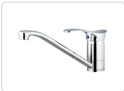
A-2062 $4,800 單槍式廚房混合龍頭（檯面上） 尺寸(mm): L=225 適用水壓範圍0.5~5kgf/cm 2
