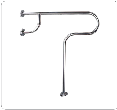
H-6156 1¼" ϕ $6,200 T型扶手 • 700深×750高mm 註：附膨脹螺絲9支 材質：不銹鋼#304（管徑 ϕ 31.8mm）
