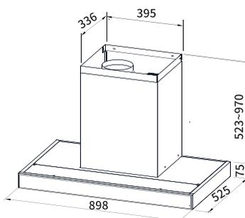
機體底部至吊掛螺絲鑽孔位置：468mm
