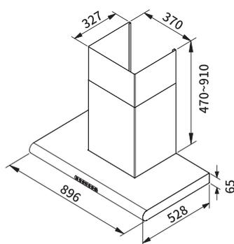
機體底部至吊掛螺絲鑽孔位置：410-424mm
