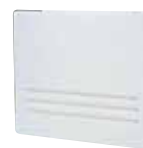
BP1503 浴缸檢修孔 $1,880 外徑尺寸：W44xH38.5cm 內徑尺寸：W40.5xH35.5cm 材 質：ABS 顏 色：白色 / 牙色
