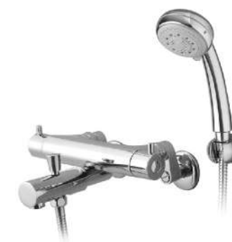
BF3916 定溫式沐浴龍頭 適用水壓：貯備型電熱水器1.5~5kgf/cm 2 瓦斯熱水器2~5kgf/cm 2 (不可搭配即熱型熱水器) 產品特色：熱水恆溫、陶瓷心軸 搭配BF3027五段式按摩蓮蓬頭
