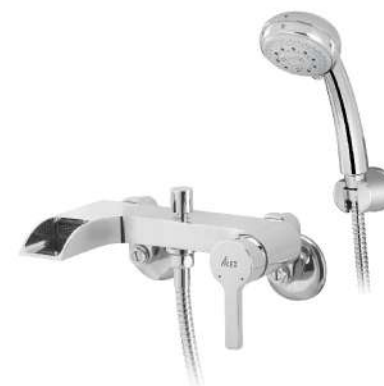
BF3571 沐浴龍頭 適用水壓：0.5~5kgf/cm 2 產品特色：陶瓷心軸 搭配BF3027五段式按摩蓮蓬頭
