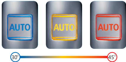
利用燈光顏色變化來表示出水的溫度，水溫 30°C 以下為淡藍光，隨著水溫上升從黃色變為橘黃色，當水溫超過 45°C 時變為紅光。水溫是否合適，可一目了然。不僅減輕了冬天苦等熱水的煩躁，也可以做為高溫出水時的警示。
