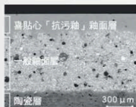
喜貼心「抗污釉」馬桶的顯微鏡片 *1 μm=0.001mm
