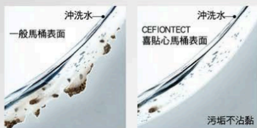
沖洗時馬桶表面的斷面放大示意圖
