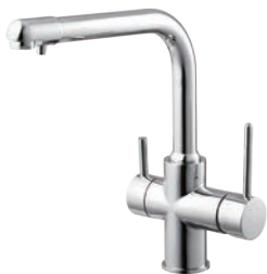
A-2069LF $14,500 無鉛RO廚房龍頭 (立式) 尺寸(mm): H=300 H1=272 L=230 材質: 銅 (鉛含量低於0.25%) ※符合CNS8088國家標準(飲水龍頭)
