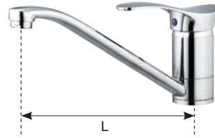
A-2062 $5,000 混合龍頭 (立式) 尺寸(mm): L=225 適用水壓範圍0.5~5kgf/cm 2
