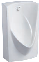
U612A NEW 感應型壁掛便斗組 $17,800 尺 寸：W43xD33xH66cm 電 源：110V、220V 通用 進水方式：背進水 排水高度：46cm 壁內管徑：1.5" 便斗給水高度：96.5cm * 建議乾式施工
