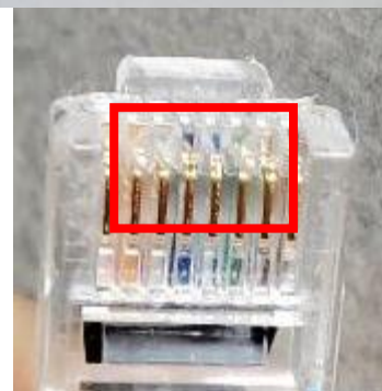
接頭磨損導致訊號接收不良
