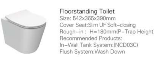
ENC2175UW 落地式座便器 尺寸: 542x365x390mm 蓋板: UF緩降薄蓋板 坑距: H=180mm (P排) 可搭配NCD03C隱藏式水箱使用 沖水系統:直沖
