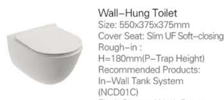
NC2140UWT0A 掛牆座便器 尺寸: 550x375x375mm 蓋板: UF緩降薄蓋板 坑距: H=180mm (P排) 可搭配NCD01C 隱藏式水箱使用 沖水系統:直沖
