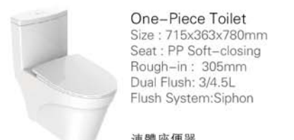
ENC2156JW-3 連體座便器 尺寸: 715x363x780mm 蓋板: PP緩降蓋板 坑距: 305mm 名義用水量: 3/4.5L 沖水系統:虹吸
