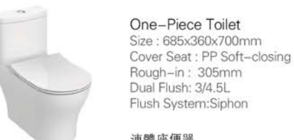
ENC2155JW-3T0 連體座便器 尺寸: 685x360x700mm 蓋板: PP緩降蓋板 坑距: 305mm 名義用水量: 3/4.5L 沖水系統:虹吸
