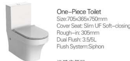
ENC2151UXW-3 連體座便器 尺寸: 705x365x750mm 蓋板: UF緩降薄蓋板 坑距: 305mm 名義用水量: 3.5/5L 沖水系統:虹吸
