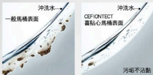
沖洗時馬桶表面的斷面放大示意圖
