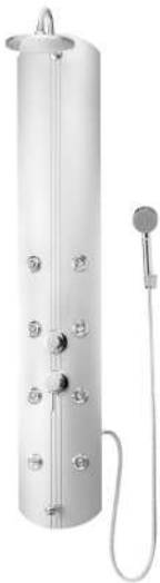
B8510 $ 16,000 品名 淋浴柱 尺寸 W 260 x H1500 mm 水壓 2.5~5 kgf/cm 2 材質 PVC烤漆 特色 按摩噴頭、頂噴、蓮蓬頭、 下出水、四路分流控制
